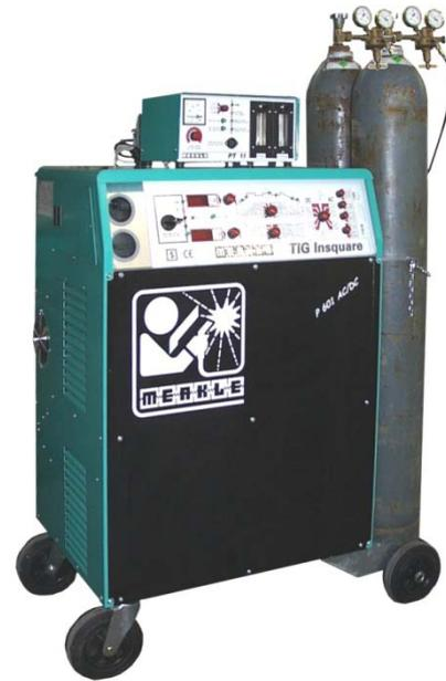
Регулятор 1: 10-ступенч. переключатель: ток 1, время 1, время подъема и спада дуги, начальный ток, конечный ток, импульс поджига, время точ. сварки, время подачи газа до и после сварки
